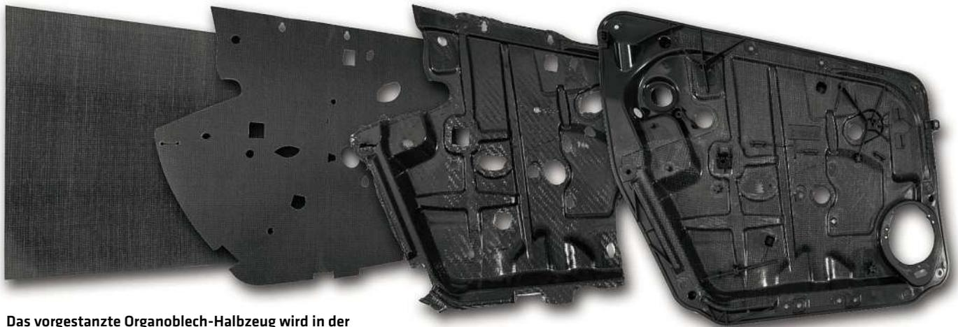
**Das vorgestanzte Organoblech-Halbzeug wird in der Spritzgussmaschine erwärmt und in Form gepresst. Gleichzeitig werden Verstärkungen und Funktionselemente aus Kunststoff angespritzt.**
