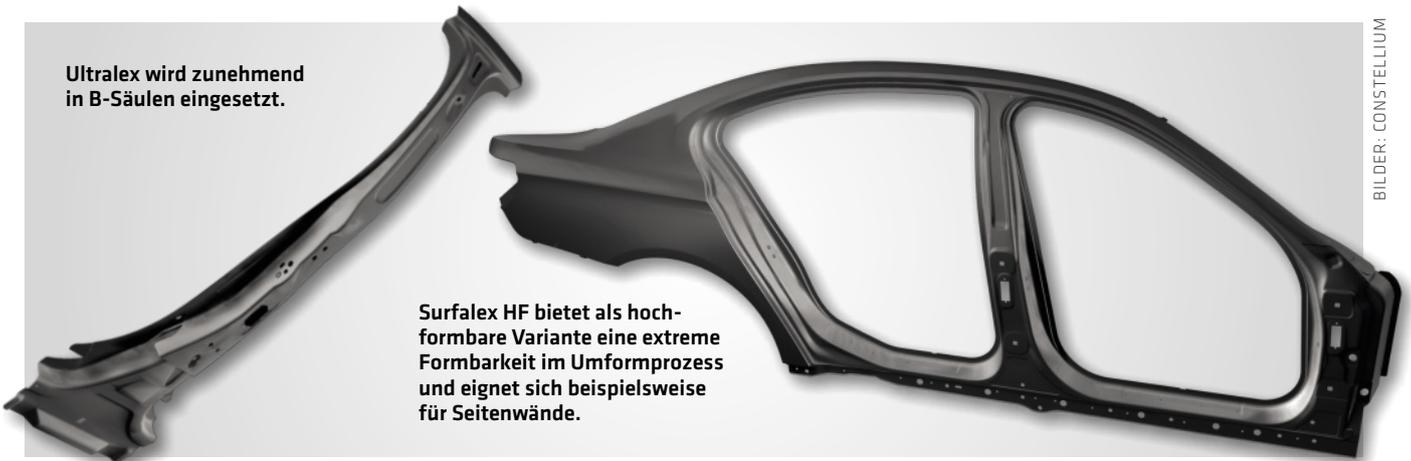
**Surfalex HF bietet als hochformbare Variante eine extreme Formbarkeit im Umformprozess und eignet sich beispielsweise für Seitenwände.**
