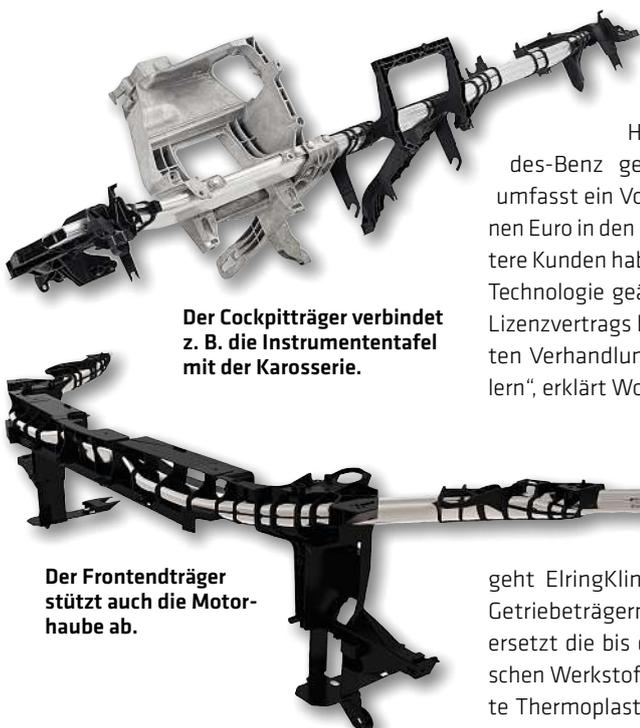
**Der Cockpitträger verbindet z. B. die Instrumententafel mit der Karosserie.**
