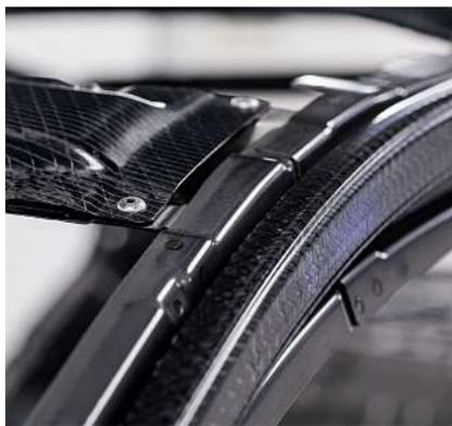
„Carbon Core“ nennt BMW die Karosseriekonstruktion aus carbonfaserverstärktem Kunststoff (CFK), Aluminium und Stahl beim aktuellen 7er.
