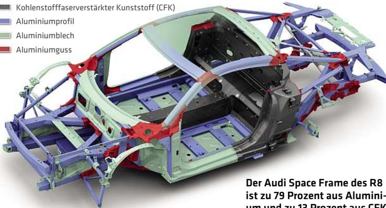
**Der Audi Space Frame des R8 ist zu 79 Prozent aus Aluminium und zu 13 Prozent aus CFK.**
