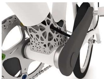
Volumenversteifungen am Tretlager eines aluminium-gedruckten Fahrrads.
