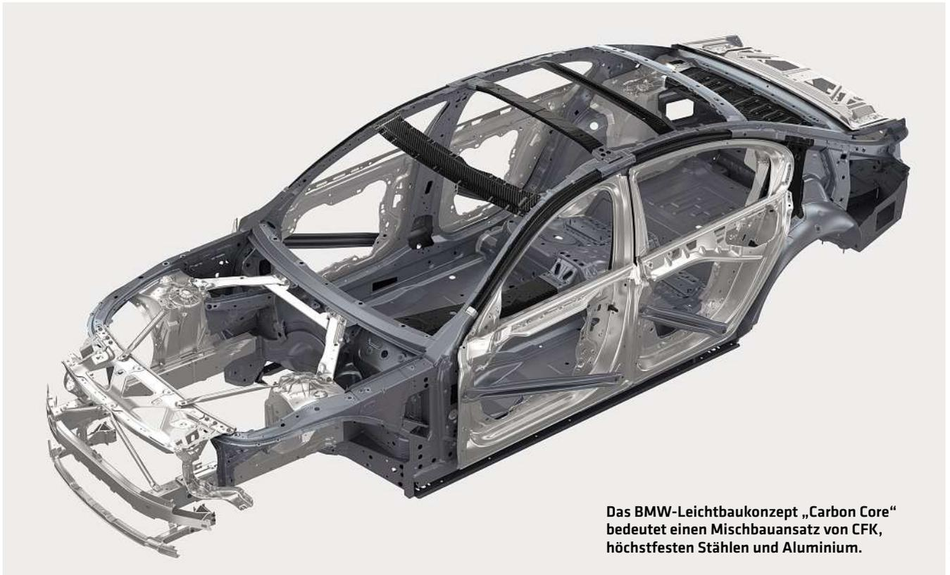
Das BMW-Leichtbaukonzept „Carbon Core“ bedeutet einen Mischbauansatz von CFK, höchstfesten Stählen und Aluminium.
