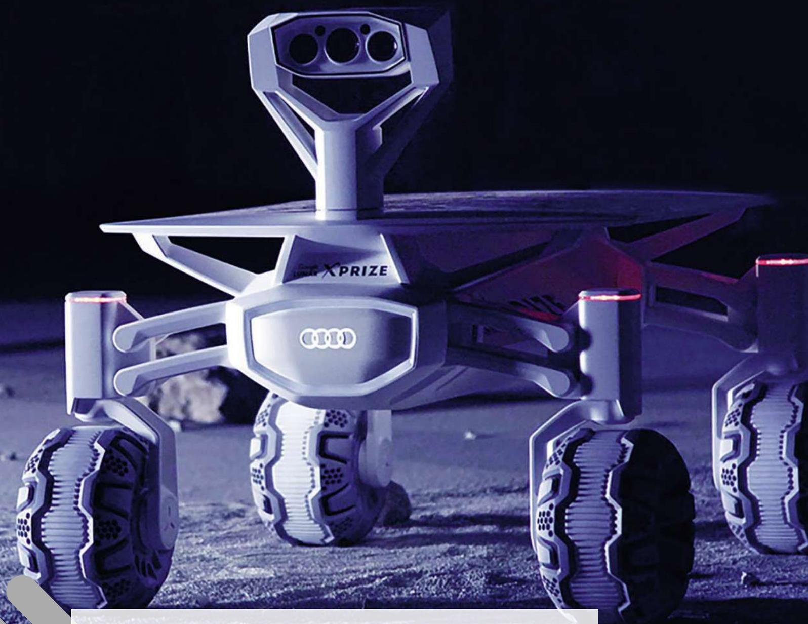
Mit dem Audi lunar quattro unterstützt der OEM die Berliner Ingenieurgruppe Part-Time Scientists bei einem Raumfahrt-Wettbewerb. Der Rover ist aus hochfestem Aluminium aufgebaut. Er wiegt 35 Kilogramm. Durch den Einsatz von Magnesium soll er künftig noch leichter werden.
